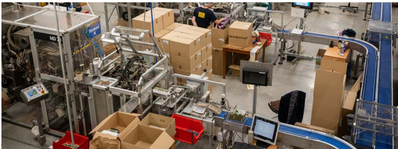
Napojení výrobní linky na balicí stroje. Krabice po kontrole hmotnosti pokračuje po dopravníku. Jakmile je naakumulováno šest krabiček, je šestice přesunuta na společný dopravník. Po něm pokračují ke značení laserem.
