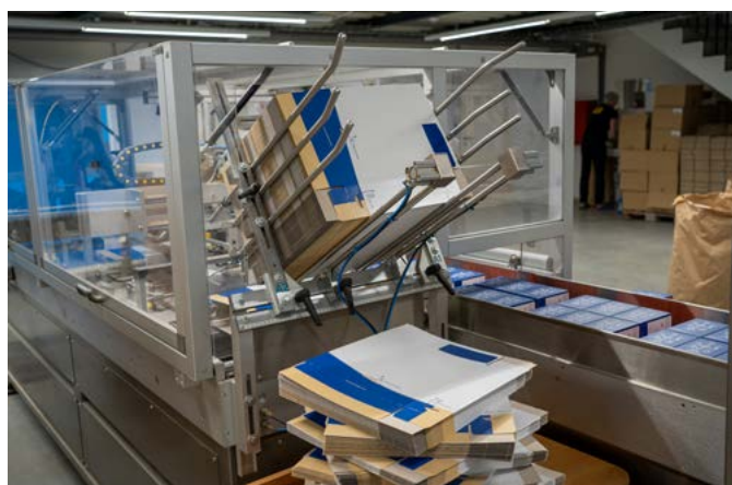
Krabičky s porcovanými čaji jsou na vstupu do kartonovačky uspořádány do dvou nad sebou umístěných trojic. Následně jsou zabaleny do obchodního balení.
