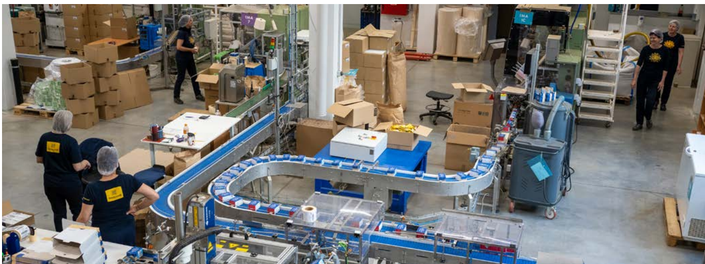
Výstup od rychloběžných balíčků. Dopravníková trasa nemá přímý tvar, aby byl dostatečný prostor pro akumulaci výrobků, pokud by se dál na lince něco přihodilo.
