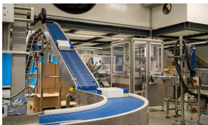
Součástí linky je i velbloudový dopravník, který transportuje obchodní balení od kartonovačky k finálnímu třídění. V budoucnu dopravník protne turistický okruh a krabice budou projíždět okolo návštěvníků.
