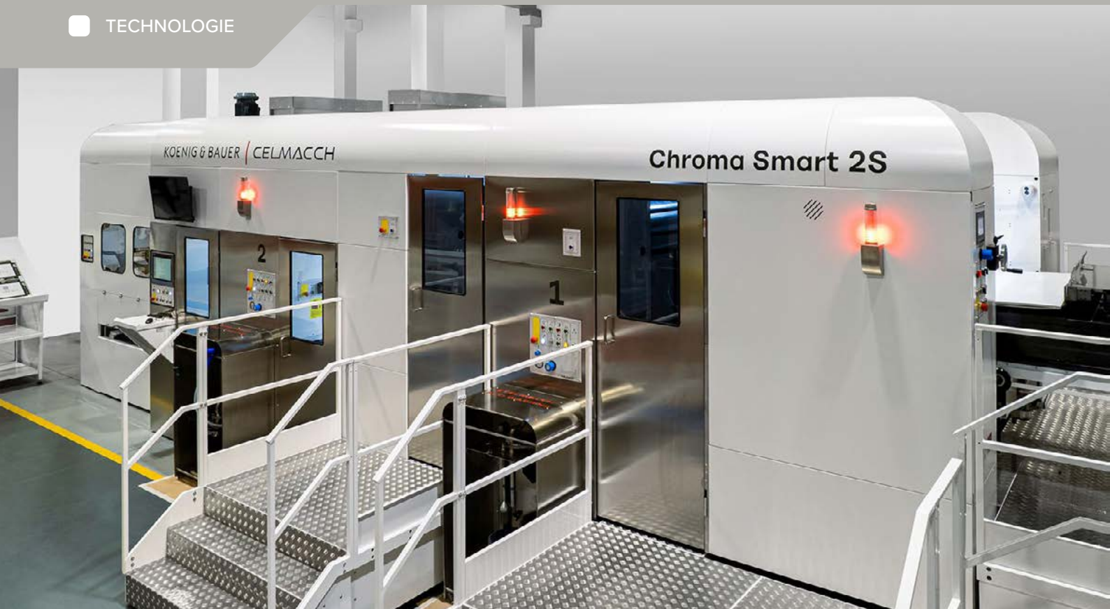
Koenig & Bauer Celmacch uvedl v březnu technologii oboustranného flexotisku na vlnitou lepenku Chroma 2S.
