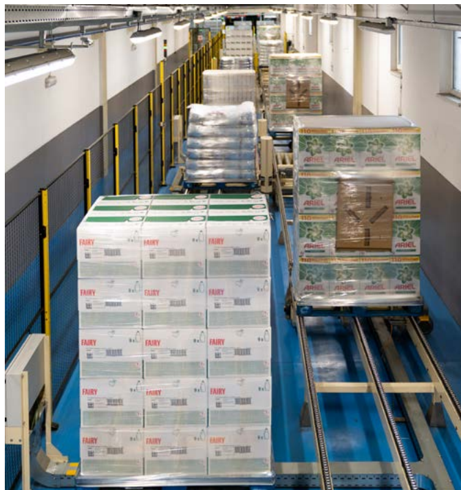
Paletová dálnice továrny Rakona zajišťuje pomocí nejmodernější IT technologie, aby všechny palety přesně a co nejkratší cestou dorazily na místo určení.
