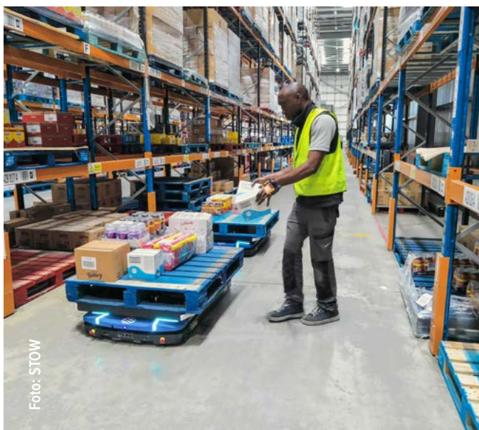
Efektivitu skladování zvyšují i mobilní podvozky iFollow, které slouží pro přepravu palet. Využívány jsou i při pickování.
