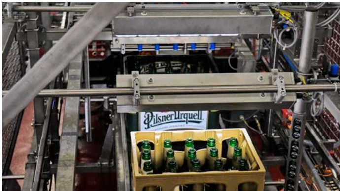
Zařízení je schopno rozeznat a třídit lahve přímo v přepravkách.
