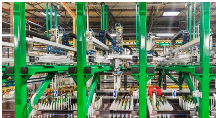
Linka zvládne zkontrolovat a poté vytřídit 4 050 přepravek za hodinu, tedy 81 tisíc pivních lahví.
