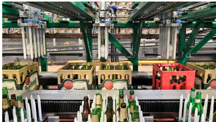
Technologie nevyžaduje mechanickou přestavbu mezi lahvemi o objemech 330 ml a 500 ml.
