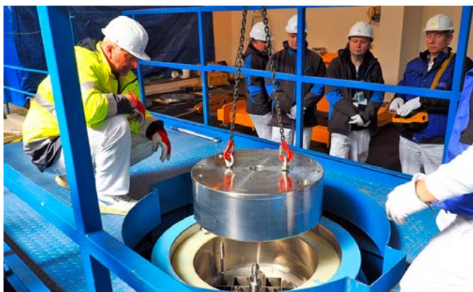
Společnost ŠKODA JS vyvinula a úspěšně otestovala v ÚJV Řež univerzální kontejner na vyhořelé jaderné palivo ŠKODA MTR-TRIGA.
