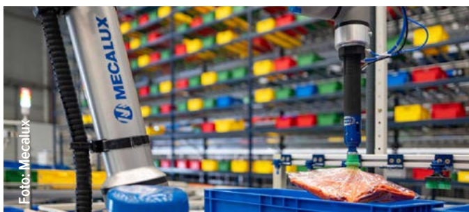
Robot zvládne tisícovku vychystávacích úkonů za hodinu.
