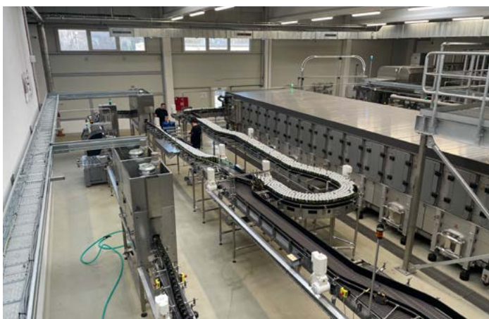
Ve výrobě nechybí tunelový paster pro šetrné ošetření nápojů v plechovkách.
