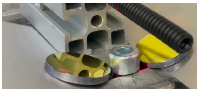
Netradiční požadavky na laserové značení vyřešila společnost LINTECH použitím zrcátek.
